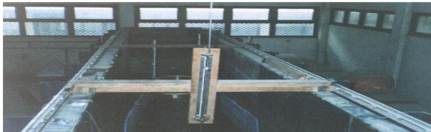
Gambar 3.1 Probe gelombang pada saluran gelombang
